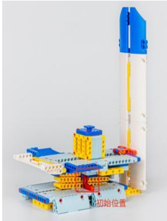
起始位置：升降台与底座红色零件完全接触
