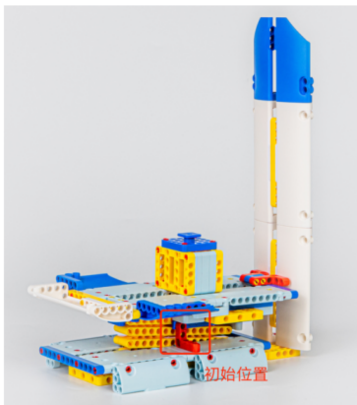
起始位置：升降台与底座红色零件完全接触
