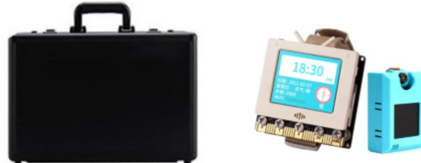
人工智能比赛套件包含视觉模块、语言模块、物联网模块等，可以完成多种比赛主题项目，配有不同种类的主控板、输入输出、通讯类模块，可覆盖各种领域项目，能够很好地完成本次比赛所设置的主题。视觉模块能够进行线路识别、机器学习、人脸识别等各种功能，可以用作垃圾分类智能应用之中。人脸识别功能可以使用在门锁之中，通过人脸识别控制电机、舵机做一个人脸识别的门锁装置。语言模块能够通过编程进行人机交互，语音识别、语音控制等，可以使用与语音交互类的设备之中，类如智能音箱。物联网模块能够链接我们的网络，从网络上可以提取我们需要的信息，比如今天的天气状况，古诗词、英语、数学等知识点，还配备基础结构件，类如销、轴等，能够将基本结构框架搭建起来，能够将各个传感器与主控器固定起来，还配有基础的工具和耗材，方便实现项目创意。
